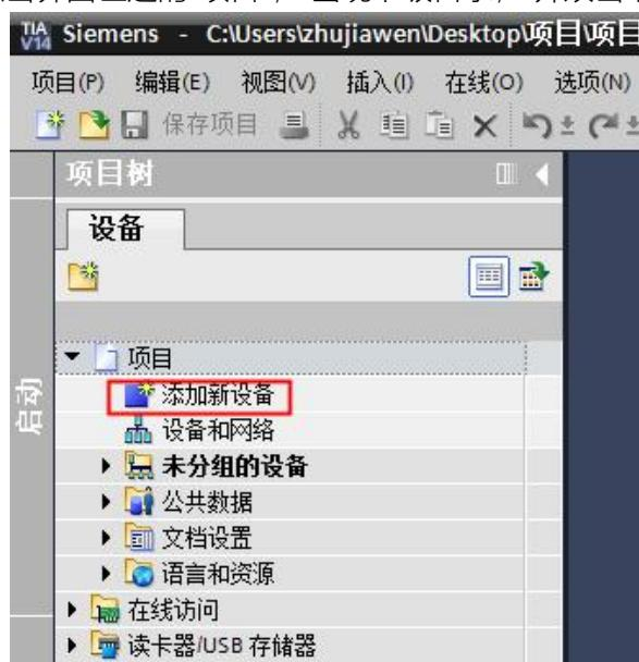
3. 弹出“添加新设备”窗口，进行“控制器→SIMATIC S7-1500→CPU→CPU 1511T-1 PN→6ES7 511-1TK01-0AB0”操作,点击确定：
