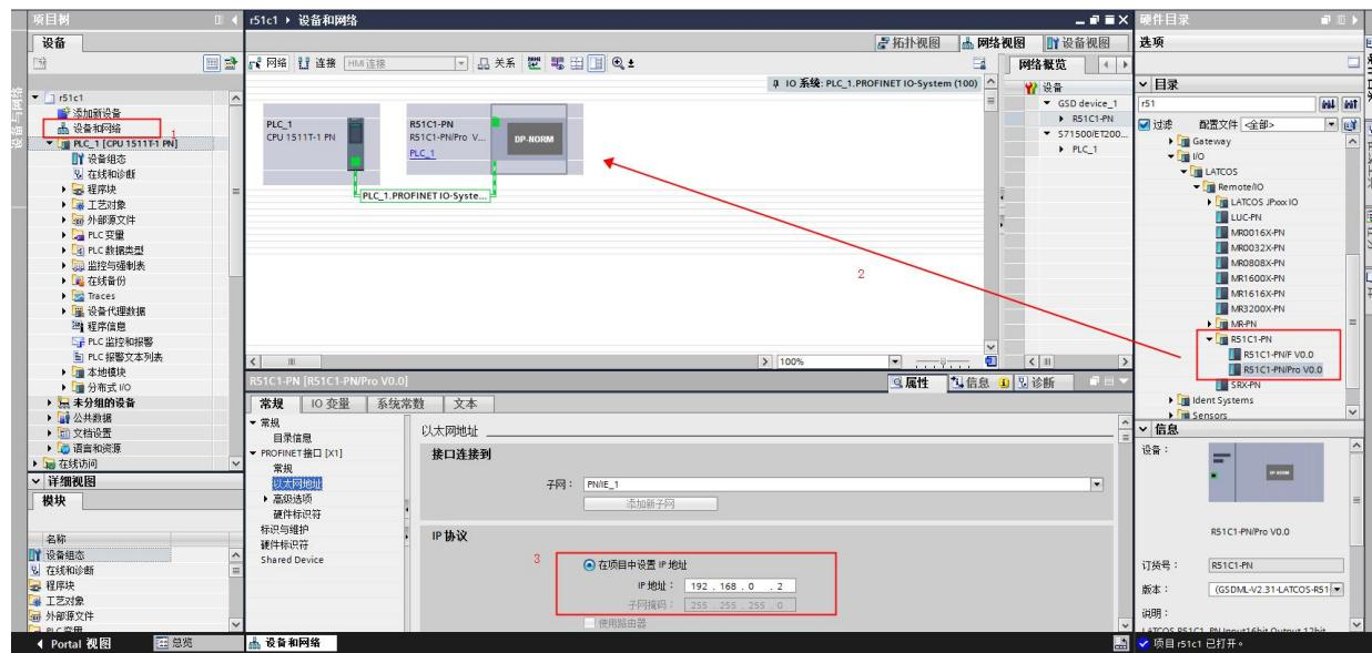
7. 在模块的未分配上左击鼠标，选择PLC\_1.PROFINET 接口\_1，即可将RX-PN的模块连入PROFINET网络中：
